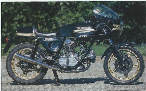
Si les premières 750 avaient un réservoir en poly, la 900, elle, possède un bidon en tôle.
