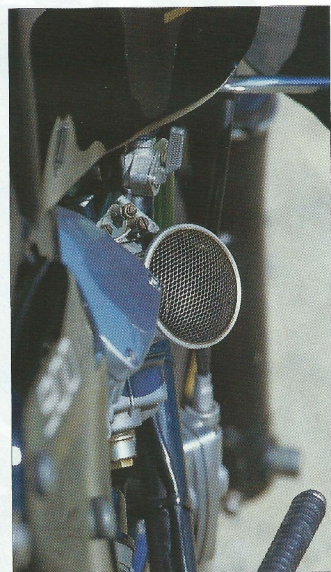
Pour respirer librement, le V-twin a besoin des gros carbus de 40 en cornet et d'échappements assez ouverts.
