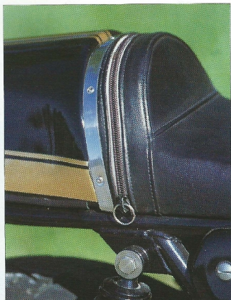
La fermeture éclair qui permet d'accéder au petit coffre ménagé dans le dossier de selle : la classe italienne.
