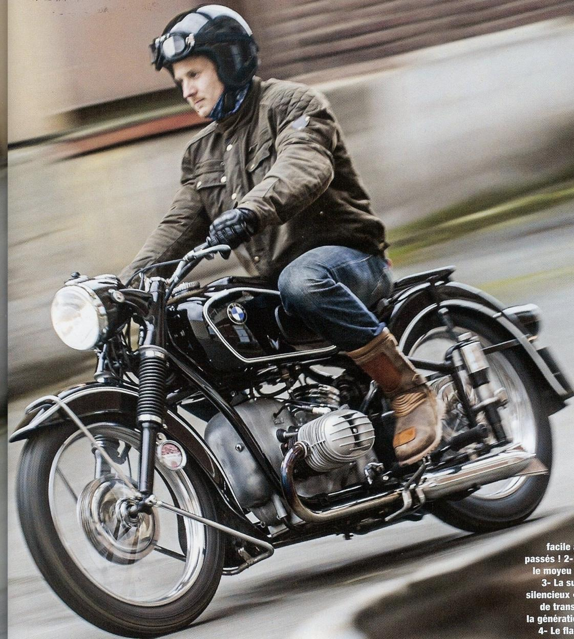
1- La R51/3 est une moto facile à vivre malgré ses 60 ans passés ! 2- Petite entorse à l'origine, le moyeu aileté par Legend Motors. 3- La suspension coulissante, les silencieux « queue de carpe », l'arbre de transmission apparent signent la génération antérieure à la Série 2. 4- Le flat culbuté est alimenté par des carburateurs Bing, évidemment !
