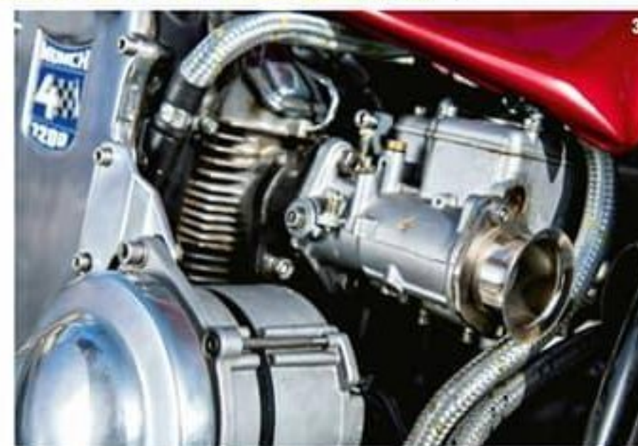
1- La descente de la béquille, c'est rien... c'est l'étape précédente qui relève de l'athlétisme. 2- Tout au long de sa production, Münch est toujours resté fidèle aux freins à tambour, de fabrication maison. 3- Après les carbs Weber double corps, Münch a été l'un des pionniers à adapter l'injection sur ses motos.
