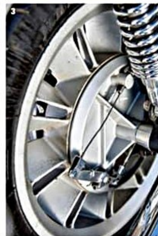
1- Côté distribution, la Mammuth donne tout de suite l'impression d'une moto hors normes. 2- Sur la Munch, on se sent intégré « dans » la machine. Son ergonomie est assez étonnante et pas assez soulignée. 3- La roue arrière est en Elektron, les rayons ne résistaient pas... 4- La platine instrument intégrée au phare est aussi maousse avec, au-dessus du tachymètre et du compte-tours, voltmètre et pression d'huile.
